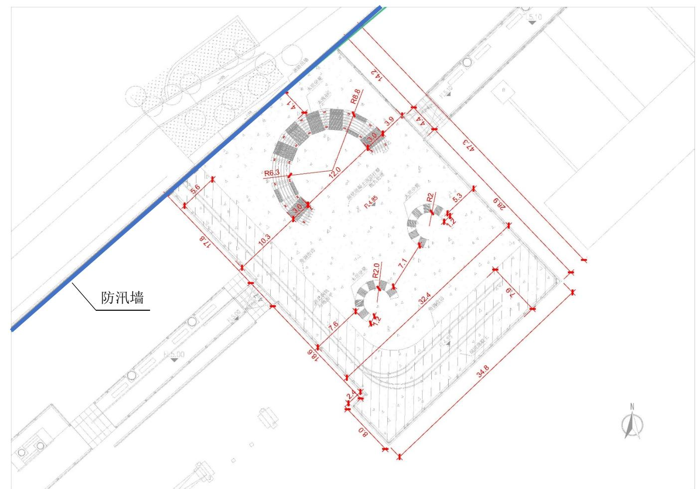
1. 场地空间描述：该场地位于原上海制皂厂的防汛墙外围，长（南北向）约47.3米，主要宽度（东西向）约32.4米。码头为钢筋混凝土结构，该结构并未加固。码头北侧布置C型的凉亭（约8.8米半径），红色混凝土作为基础与座位，上部为碳化木廊架。南侧布置两处C型座凳（约2米半径）。
